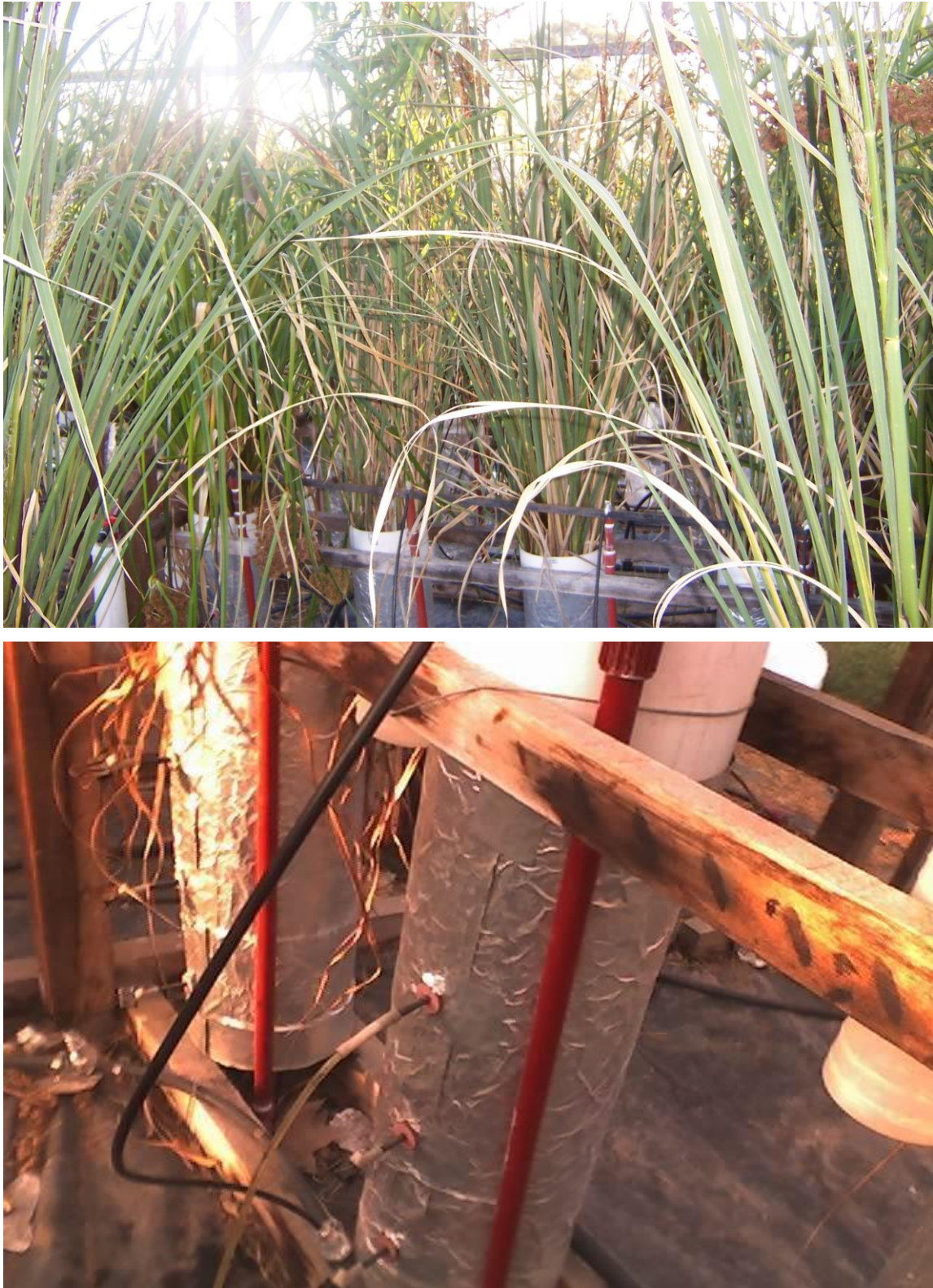
Figura 3.2. Fotografías de los mesocosmos plantas (arriba) y detalle de las tomas de muestra a distintas profundidades (abajo).
