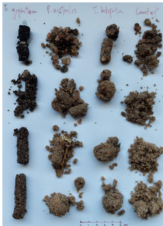
Figura Suplementaria 5.2. Perfil de ORP en los mesocosmos (día 430, invierno) y fotografías de los rellenos de mesocosmos con E. giganteum , P. australis , T. latifolia y control a profundidades de hasta 5, 10, 15 y 20 cm. Se observa la presencia de materia orgánica oscura y un efecto de agregación de la arena con E. giganteum .
