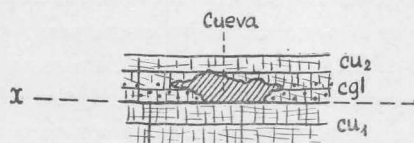
Fig. 6. — Tipo de cueva, causada por erosión eólica sobre todo en el conglomerao
