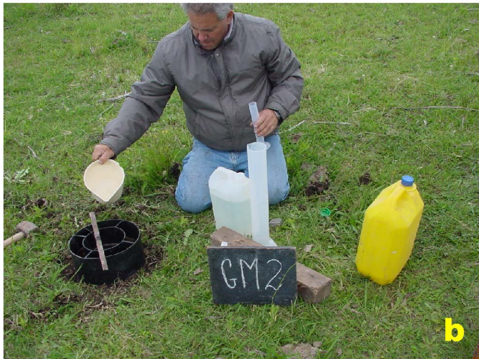
Fig. 2. Ensayos de infiltración. a) en el sitio GM1. b) en el sitio GM2.
