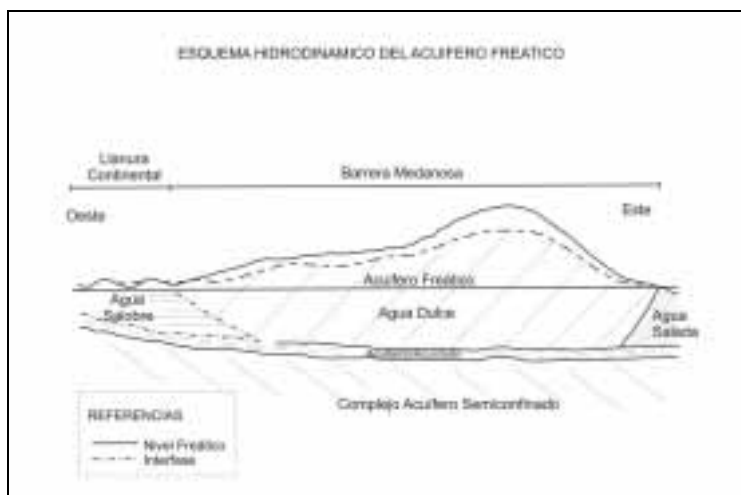
Fig. 3. Esquema hidrodinámico del acuífero freático en relación a los ambientes geomorfológicos (modificado de Consejo Federal de Inversiones, 1990)
