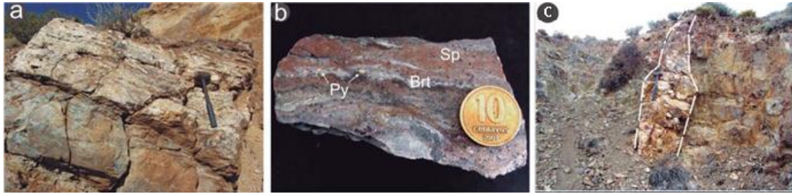
Figura 4: Mina Arroyo Nuevo, Cura Mallín. a) Banco barítico laminado alojado en pelitas de la Formación Los Molles. b) Muestra de mano donde se observa la textura laminada de baritina (Brt), esfalerita (Sp) y pirita (Py) del tercio inferior del banco barítico, diámetro de moneda = 10 mm. c) Veta de baritina en niveles superiores del yacimiento. Fotos obtenidas de de Barrio et al., (2014).
