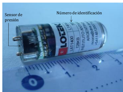
Figura 5.1: Registrador de tiempo y profundidad Lotek®, modelo LAT 1400 (128 K de memoria).
